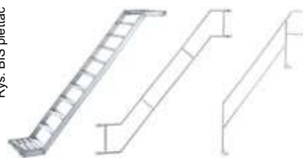
Rys. 5. Przykładowe rozwiązanie systemowe: schody oraz poręcz plettac
